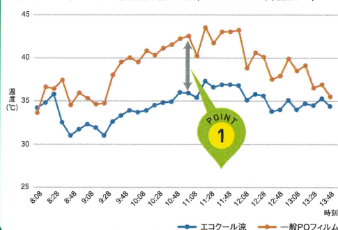
■イチゴハウスによる温度比較実験（2024/8/19 自社調べ）
