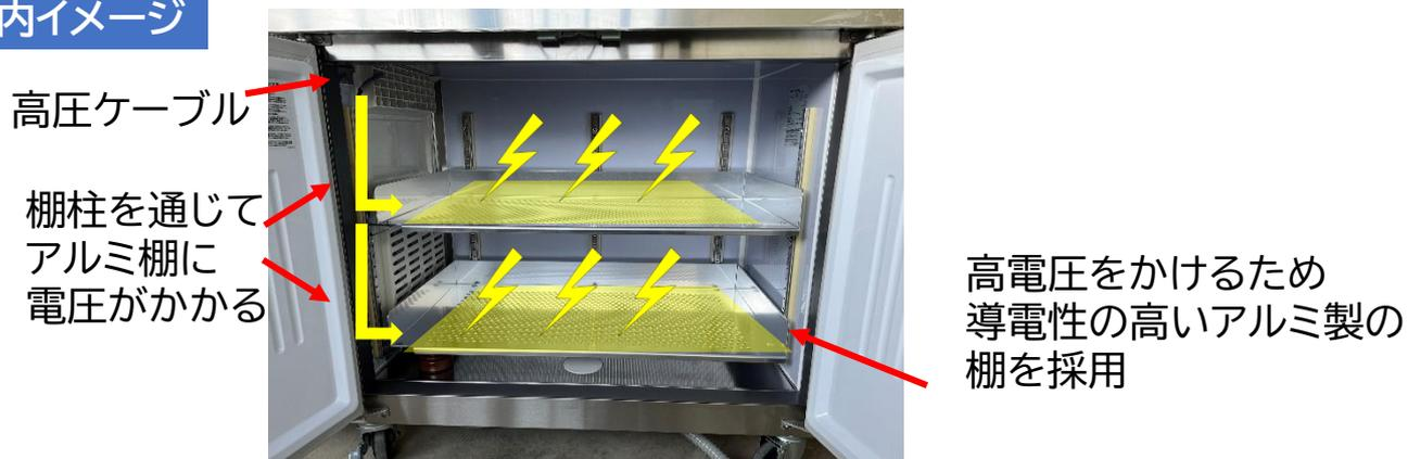
棚に置いた食材に直接電圧がかかる(直接電場)
