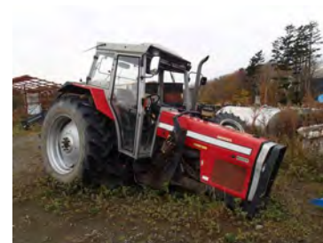
事故機の様子(フロントガラス全面破損)
